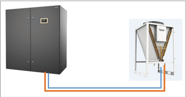
图 1 风冷直膨冷却机房空调系统架构图
