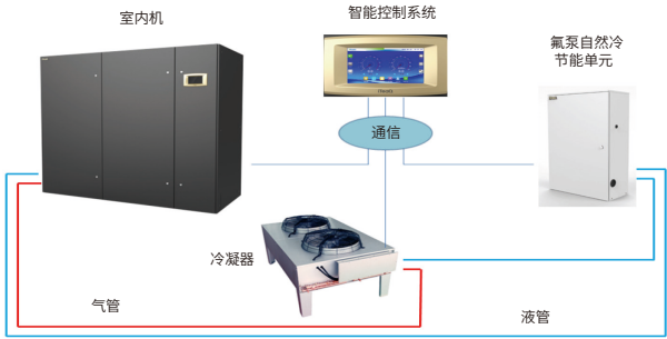
图6 风冷氟泵冷却技术系统架构
